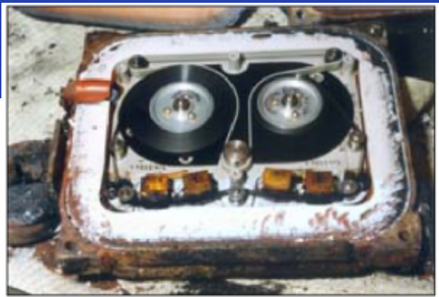
Gambar 6: Bagian Dalam FDR dengan Media Rekam Berupa Pita Magnetik yang Masih Selamat Walaupun Pelindungnya Sudah Rusak[9]
