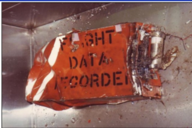
Gambar 5: FDR dengan Pelindung Yang Telah Rusak[8]
